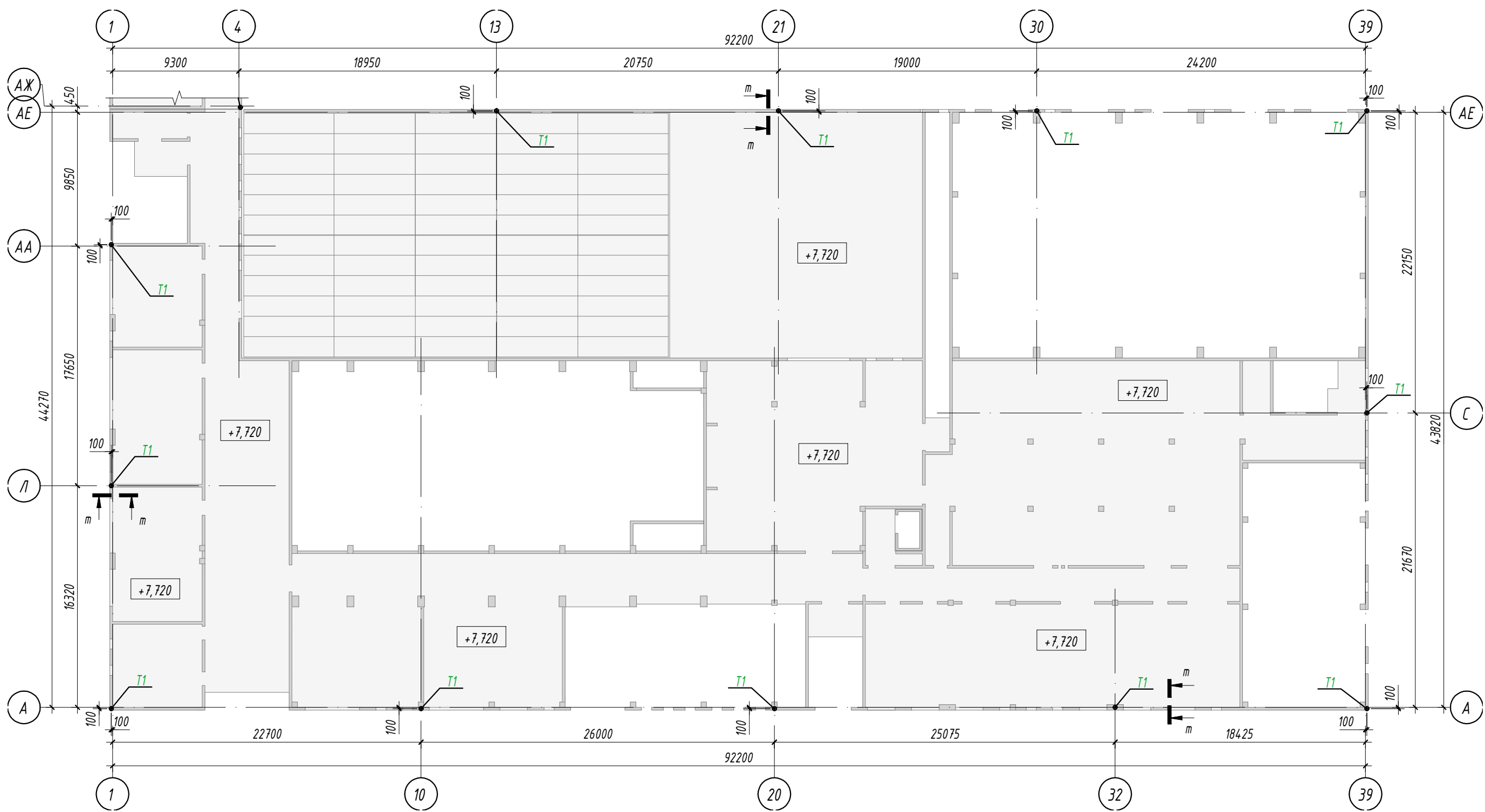
Блок 2. Схема расположения молниезащиты в стенах 3 эт.
